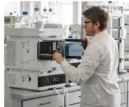
Analytische Prüfung mittels HPLC
