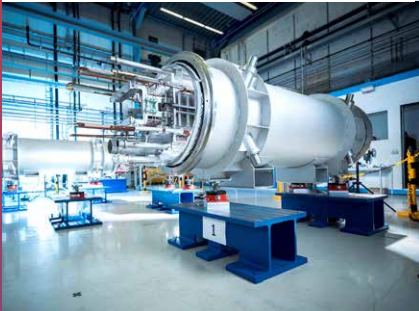
Magnete für den zukünftigen FAIR-Ringbeschleuniger SIS100 Bild: J. Hosan, GSI/FAIR
